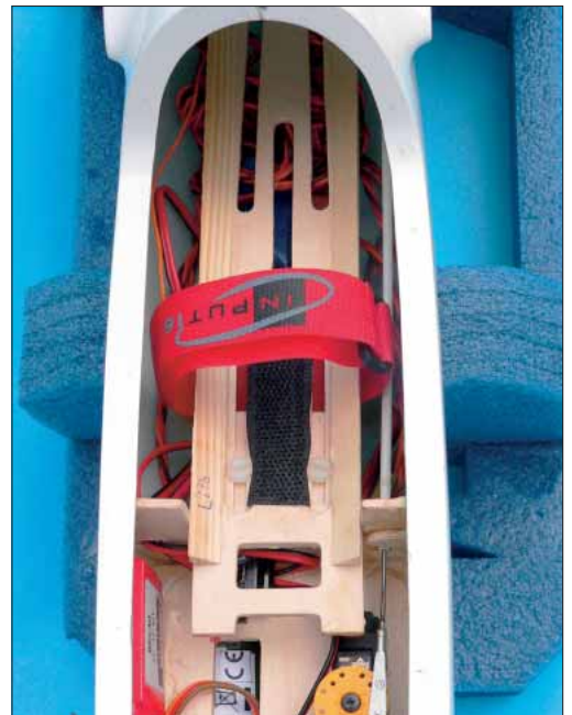
Hier gut zu sehen: die im Text beschriebene Akkurutsche
