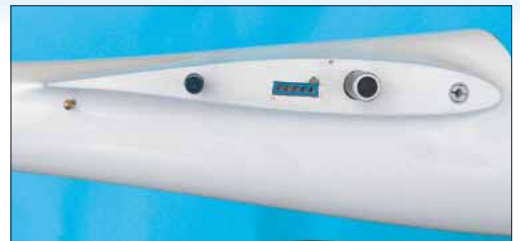
Der Tragflächenanschluss am Rumpf mit allen nötigen Partnern
