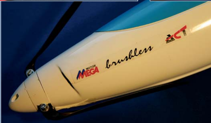
◀ Die Rumpfnase mit dem Arbeitsplatz des MEGA 600/20/6. Zwei große Lufteinlässe sorgen für ein angenehmes »Arbeitsklima« für den kleinen Kraftprotz und die Stromquellen.
