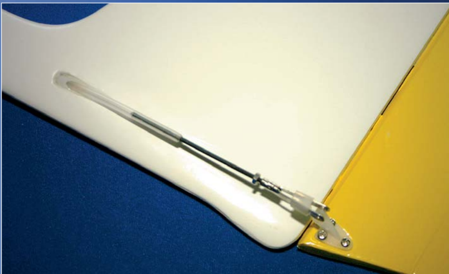
Die Bowdenzüge für Höhen- und Seitenrudder sind schon eingebaut und mit Gabelköpfen versehen. ▼
