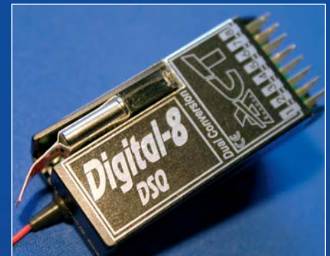
▲ Der Digital-8 DSO-Empfänger hat sich hervorragend bewährt. Auch bei den erschwerten Bedingungen beim Betrieb mit einem 600er Bürstenmotor zeigten sich beim Fliegen keinerlei Störungen oder unkontrollierte Servobewegungen.
