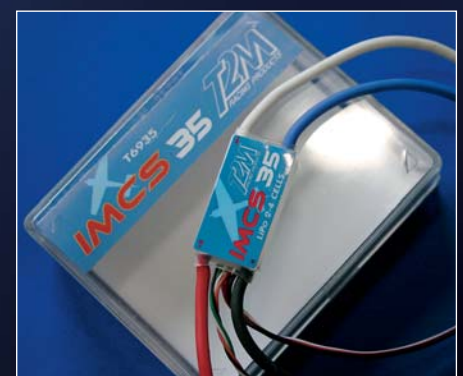
Als Regler kam ein IMCS 35 für Bürstenmotoren zum Einsatz, der sehr willig die übertragenen Arbeiten ausführte. Auch dieses preiswerte Teil ist bei Staufenbiel zu haben. ▼
