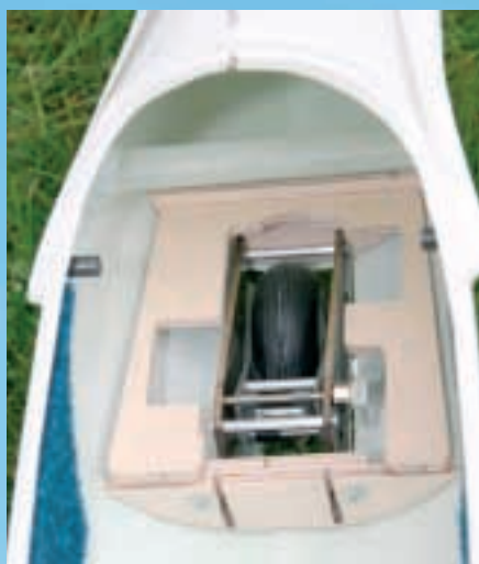
Die Spanten für das Fahrwerk sind großflächig mit dem Rumpf verklebt, das Einziehfahrwerk mit Rad passt perfekt hinein und ist von guter Qualität
