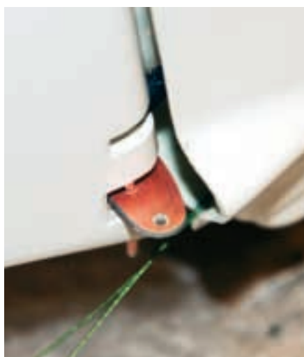
Die geänderte Seitenrudderanlenkung: ein GFK-Plättchen wurde in die Aussparung eingebracht. Die Anlenkungspunkte sind nun weit entfernt vom Drehpunkt. Ein spielfreies und rückstellgenaues Ruder ist die Folge
