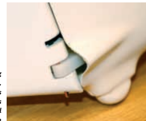
Die ausgeschnittenen Ruder sind sehr leichtgängig und die Verkastung besteht aus hartem Balsaholz
