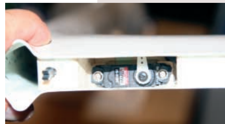
Die ausgeschnittenen Ruder sind sehr leichtgängig und die Verkastung besteht aus hartem Balsaholz
