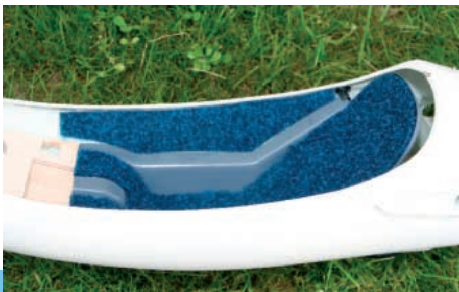
Die Cockpitwanne ist aus dem Bausatz heraus fertig gestellt. Sogar die Rumpfsseitenwände sind mit „Auslegeware“ beklebt
