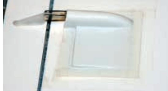
Die ABS-Abdeckungen für die Querruderservos liegen dem Bausatz bei
