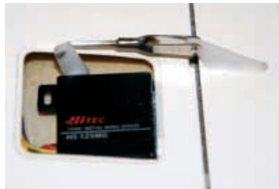
Querruderanlenkung über Stahldraht, Gabelkopf und Kunststoff-Ruderhorn aus dem Bausatz
