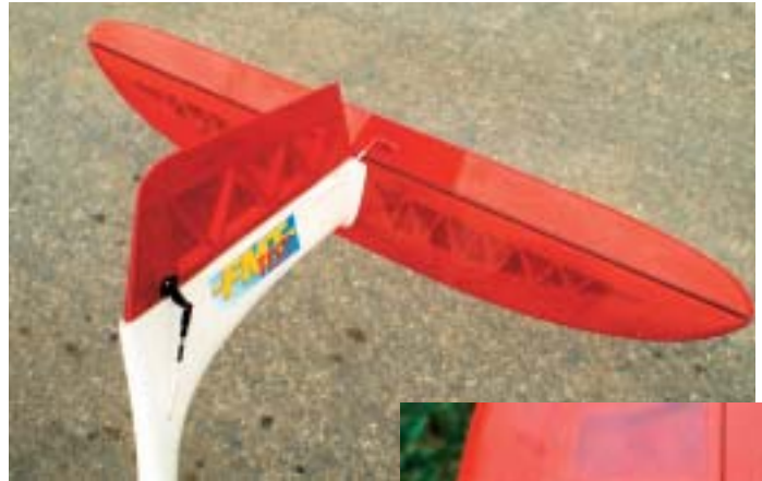
▲ Die Anlenkung des Höhenruders ist clever gemacht – zudem ist das HLW abnehmbar
