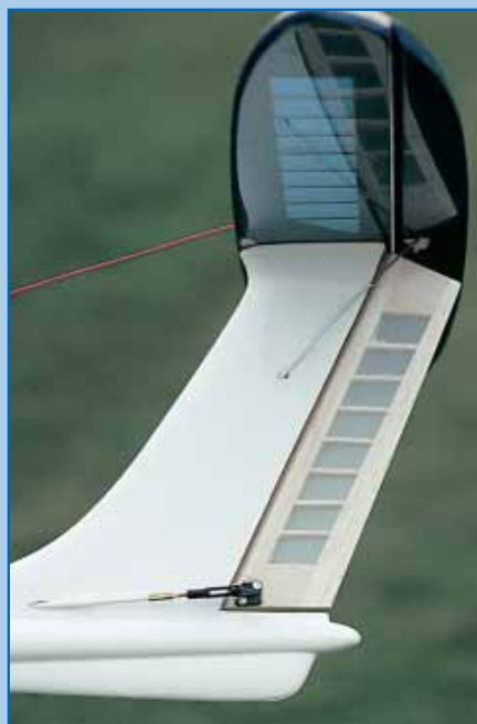
Kaum zu glauben, aber dieser Zwerg von einem Seitenruder zeigt tatsächlich Wirkung! Auch zu sehen: Der im Bogen verlegte Bowdenzug zur Ansteuerung des Höhenruders wird seitlich aus der SL-Dämpfungsflosse herausgeführt. Nicht gerade elegant, aber zweckmäßig
